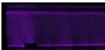
Рисунок 11. Равномерное свечение объёмного разряда в отсутствии УВ
