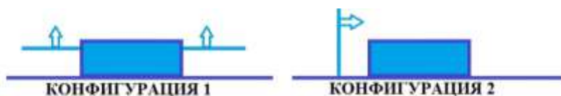
Рисунок 3. Схема прохождения ударной волной препятствия в двух конфигурациях: конфигурация 1 – дифракция от плазменного листа на обратном уступе; конфигурация 2 – дифракция на задней стенке.
