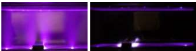
Рисунок 4. Снимки свечения объёмного и поверхностного разрядов, P \approx 2 \pm 1 торр.
