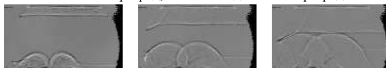
Рисунок 6. Теневая съёмка прохождения ударной волной препятствия в конфигурации 1 – дифракция ударной волны от плазменного листа на обратном уступе, образованном верхней плоскостью препятствия: поверхностный разряд, начальное давление в разрядной камере 26 торр.
